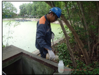
บ่อกักสุดท้ายก่อนระบายออกสู่แหล่งน้ำสาธารณะ ชุดที่ 2
